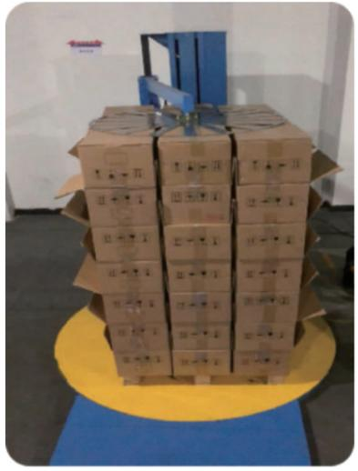
自动绕膜机替代人工绕膜
